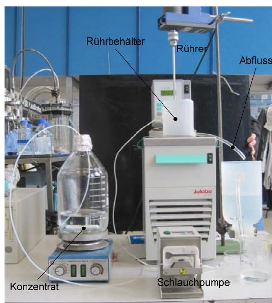
Abbildung 3.2: Versuchsaufbau Rührreaktor
