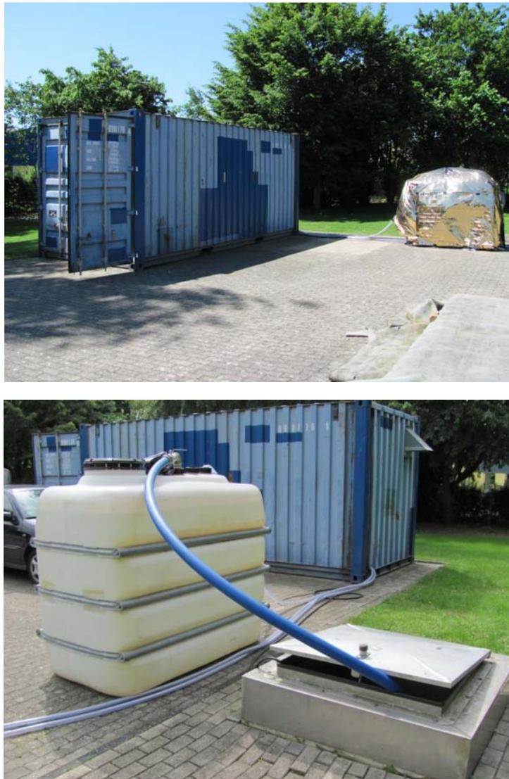
Abbildung 4.1: Versuchscontainer, Vorlagebehälter und Leitung zum Tiefbrunnen
