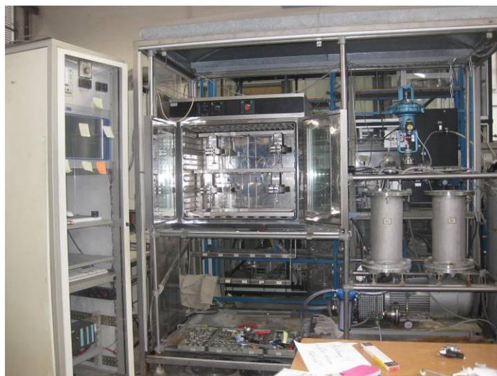
Abbildung 2.5: Versuchsanlage Cross Flow Filtration
