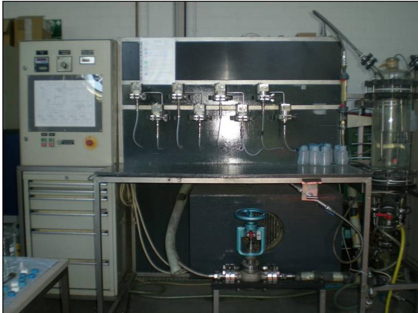
Abbildung 2.1: Cross-Flow-Anlage, die zum Membranscreening verwendet wurde
