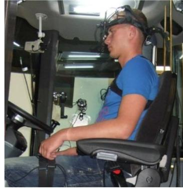
Abbildung 11: EyeLink II Eyetracking System (links), Proband im VR-Simulator (rechts)
