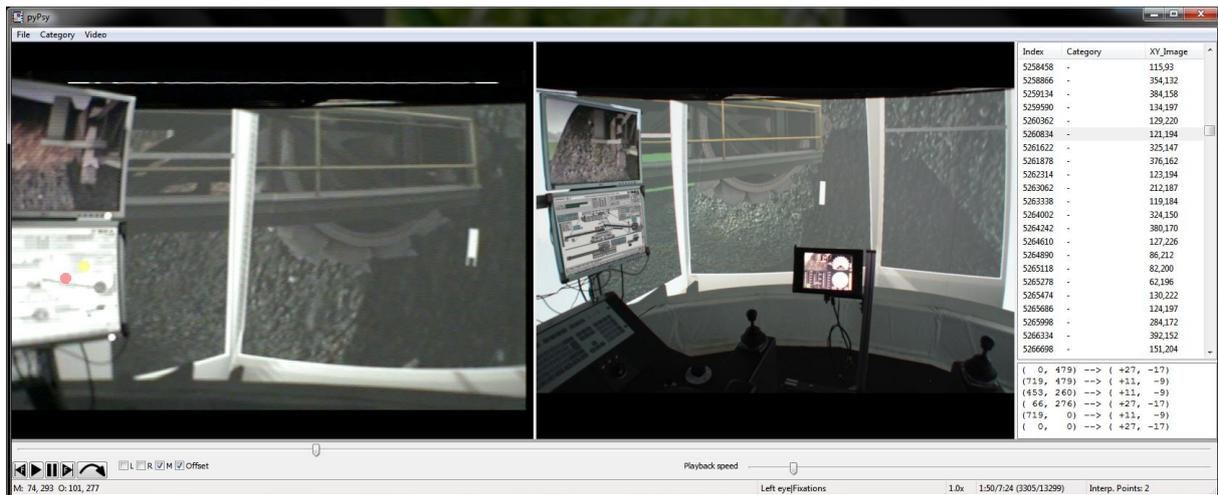
Abbildung 17: Screenshot der entstandenen Software FixCat, Videostandbild mit überlagerter Blickposition (links) und Referenzbild zur Kategorisierung (rechts)
