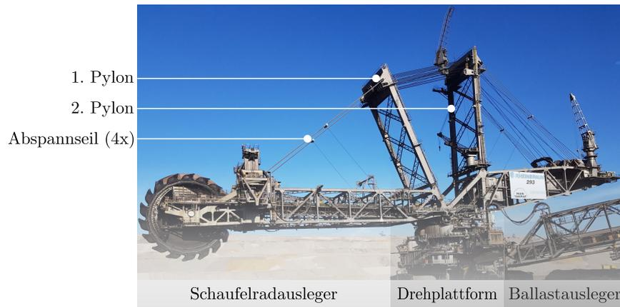
Abbildung 4.10: Übersicht zur schwingungsfähigen Stahlbaustruktur des Baggeroberbaus
