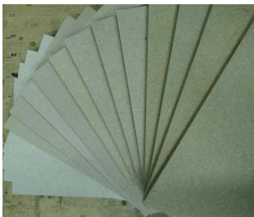
Abbildung 17: Labortechnisch hergestellte MDF mit 0,5 % Hydrophobierungsmittel und 12 % UF-Harz unter Variation der Holzarten
