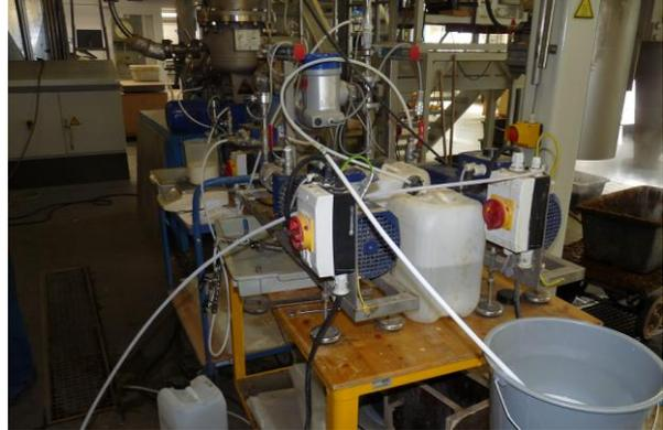
Abbildung 5: Labortechnische Blowlinebleimung am IHD
