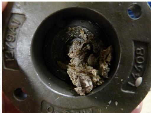
Abbildung 56: Ablagerung in Pumpe, nachdem RO-03 dort hohen Scherraten ausgesetzt wurde.
