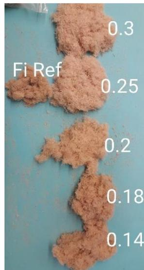
Abbildung 32: Variation des Mahlspaltes (Angabe in mm) bei Dämmstofffaserstoffen
