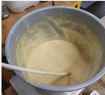
Abbildung 46: Sprühfähiges Weizenprotein-Bindemittel auf Basis einer speziellen Gluvital-Rezeptur
